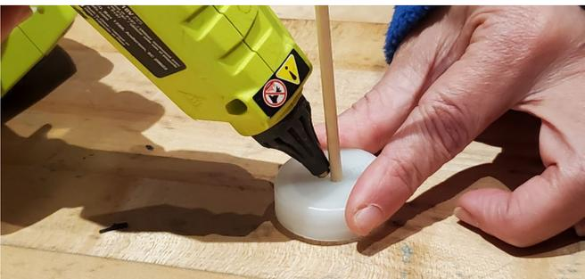
9. Coloca el pasador de madera a través de la pajilla que está unida perpendicularmente al cuerpo del dron.
