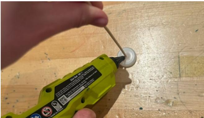
3. Una vez que las espigas estén secas, coloca las tapas de botella en cuatro lugares en el fondo del recipiente de plástico. Una vez que el equipo acuerde la ubicación, utiliza la pistola de pegamento caliente para fijar los pilares al recipiente de plástico.
