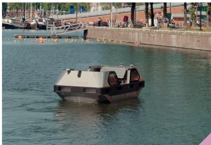
El "Roboat" autónomo que se ve en *Ciudades del Futuro* utiliza lidar para autonavegarse.
