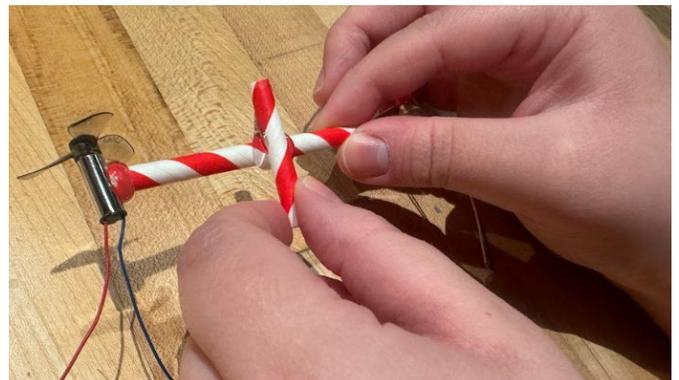
5. Conecte el cableado eléctrico rojo con rojo y negro con negro. Retuerce los cables entre sí como retuerces los cierres de pan.
